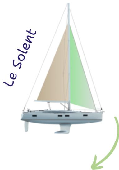
Voile d'avant utilisée lorsque le vent vient de devant. Il est plus petit que le génois, a un recouvrement de 100%, et se déploie jusqu'au mât.
